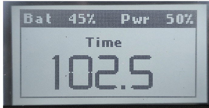
Figura 3.2 — Display LCD del LucchiMeter BASIC durante una misurazione, con indicazioni di Bat, Pwr e tempo Time in microsecondi
