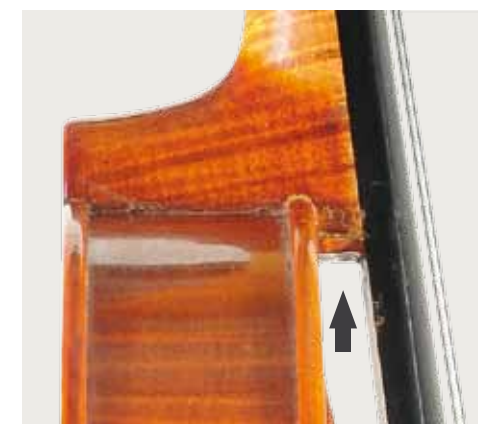
Fig. 23 - Particolare dell'incastro del manico / Detail of the neck graft
