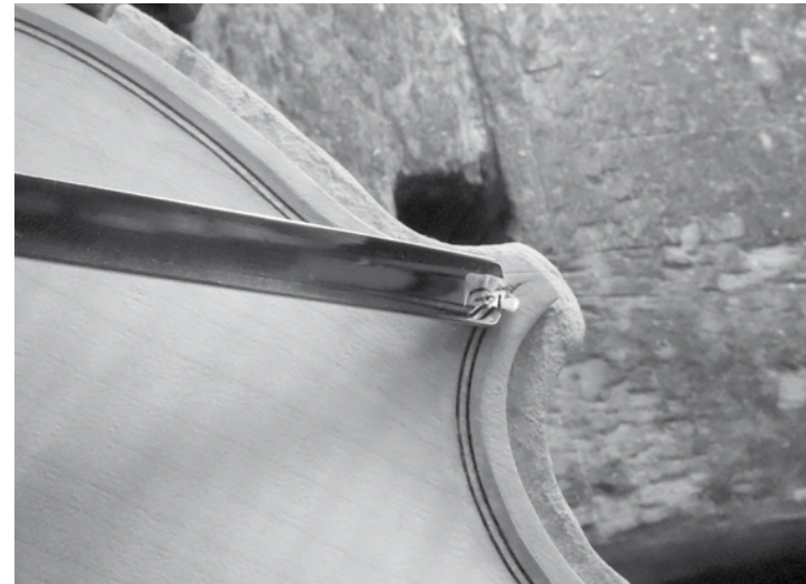
Fig. / Figs. 9-10 - All'inizio Igino Sderci procedeva dai due lati verso l'estremità della punta... / Igino Sderci began by proceeding on both sides towards the corner...
